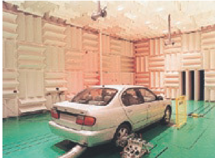
Innenansicht eines großen Reflexarmen Schallmessraumes
