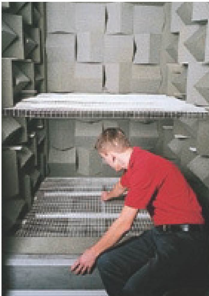
Innenansicht einer MINI-Freifeld-Kabine
