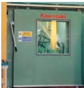
Раздвижные двери, тип NOISE-LOCK, акустическая капсуляция для прецизионного станка
